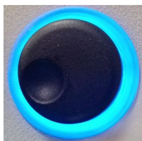
Рисунок 7 – Цвет кольцевого светодиодного индикатора вокруг манипулятора на время загрузки ПО в изделие
