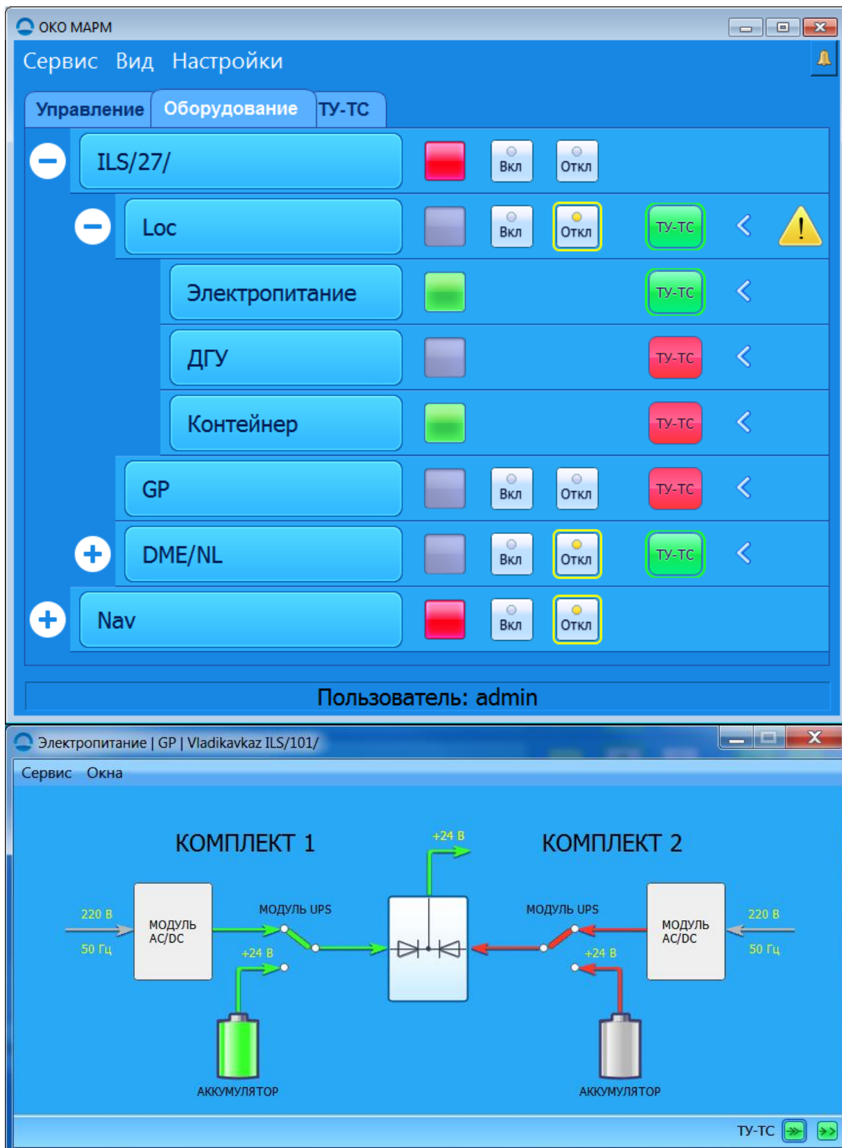
– Рисунок 2.11 – Функциональная схема системы питания шкафа
